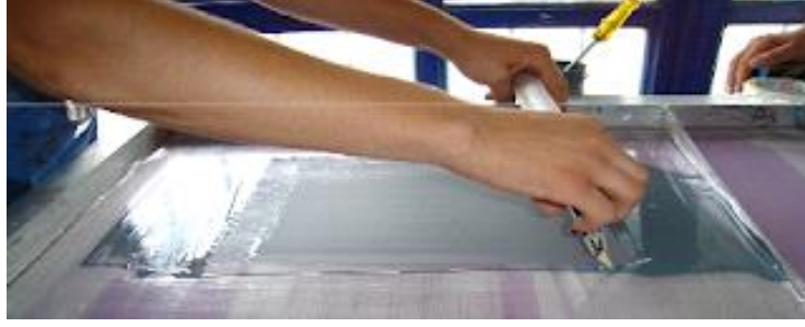
Resim 8. İpek baskı tekniği, Kasnak ve ragle.
