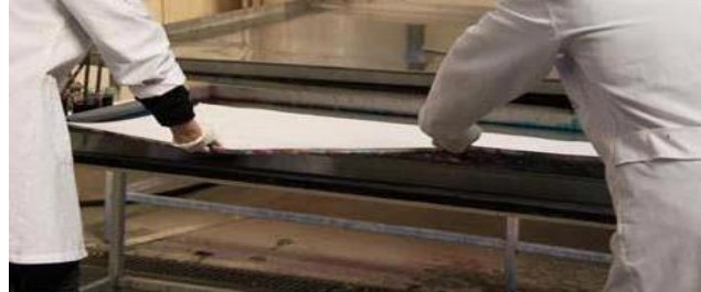
Resim 19. Halının boyayı emdikten sonra teknedeki çıkartılması işlemi
