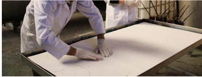
Resim 18. Halının tekne içinde boyayı çekmesi için yapılan işlem
